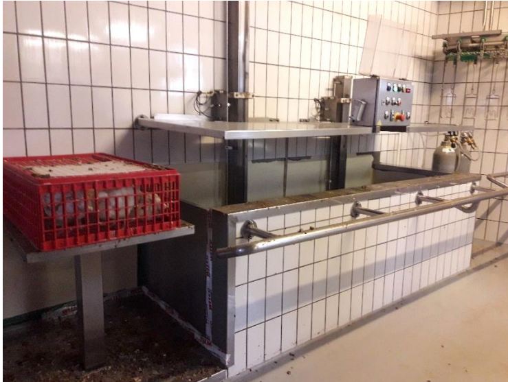
Abbildung 1: Gasbetäubungsanlage für Geflügel mittels CO 2 für Kleinschlachtbetriebe mit zwei Hubwerken (Bildbeschreibung: links: hydraulischer Kistenheber, oberhalb Schacht: Abdeckung und Bedienpult, vor Schacht Gleitschienen für die schonende Manipulation der Kisten), © tierschutzkonform.at
