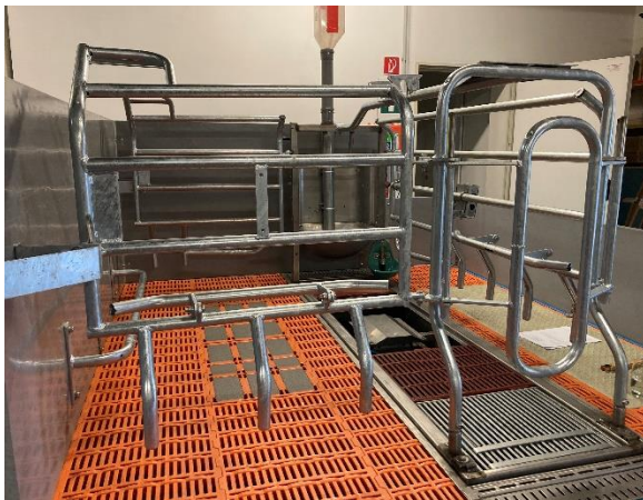
Abbildung 3: Abweisstangen und hintere Standfüße am Abferkelstand der Multi-Lib Laterale Abferkelbucht mit Hubboden Cosy – S , © tierschutzkonform.at
