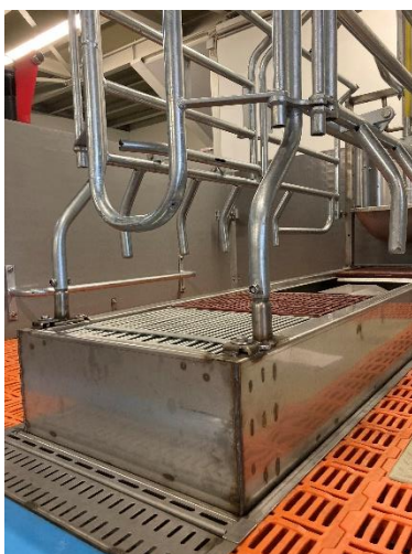
Abbildung 2: Edelstahlrahmen des Hubbodens Cosy - S mit Abferkelstand der Multi-Lib Laterale Abferkelbucht, © tierschutzkonform.at
