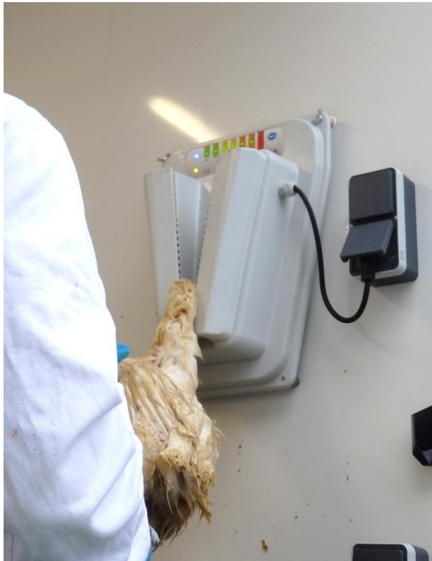
Abbildung 33: V – Elektrode zur Elektrobetäubung, © tierschutzkonform.at
